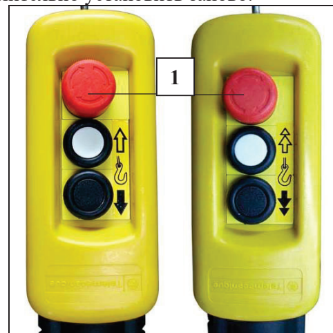
Рис. 2 Кнопка аварийного выключения
