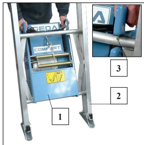
Рис. 31 Установка канатной лебедки
