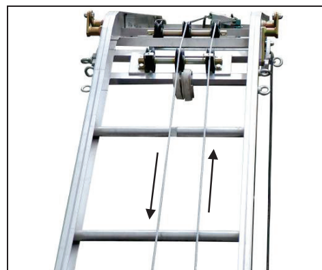
Рис. 37 Обводка каната на шарнирной детали
